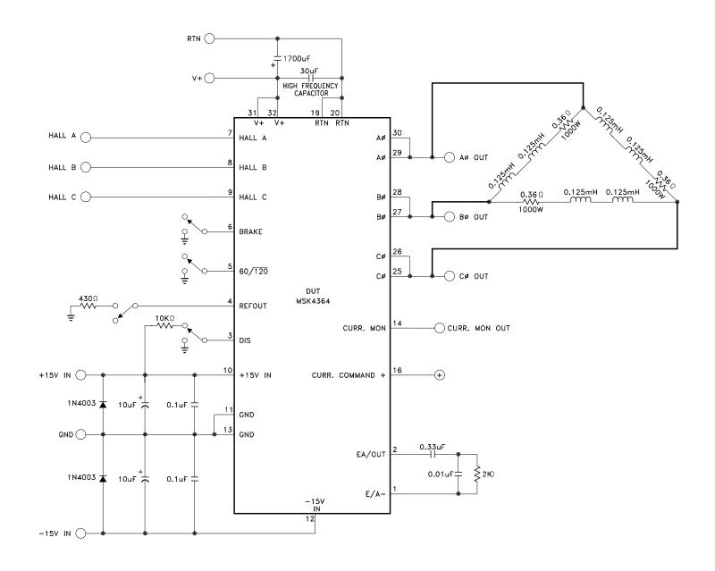
TYPICAL TEST SCHEMATIC
